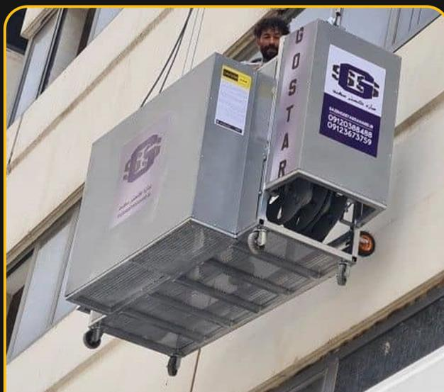
با مونوریل سطح دسترسی تکنسین ها و کارگران به قسمتهای مختلف ساختمان افزایش می یابد. آنها بسیار موثرتر و ایمن تر از داربست های موقت و نردبان های صنعتی و حتی دستگاههای هیدرولیکی هستند
